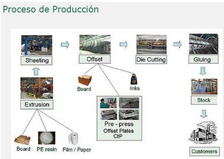
Foto: Diagrama del proceso de producción.
