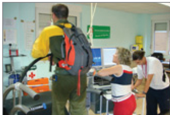
Foto 11. Prueba de esfuerzo en el laboratorio de valoración de la condición física para análisis de la tensión fisiológica y el estrés térmico inducida por los tipos de EPI.
