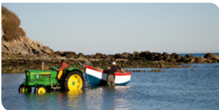
I-8. Tractores usados para botar buques (Jonas Zetterberg © Unión Europea).
