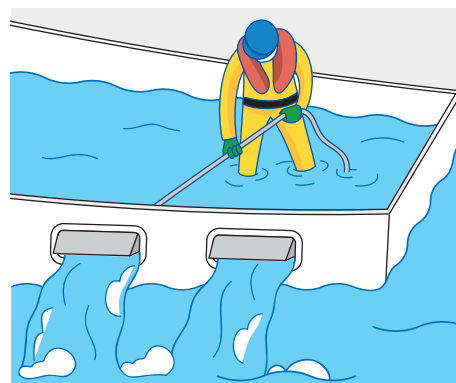
VI-7. El agua en la cubierta fluye produciendo un efecto de superficie libre (adaptado de Transport Canada, 03/2003).
