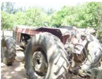
Tractor sin protección para el operador
