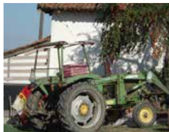
Tractor con protección contra el vuelco
